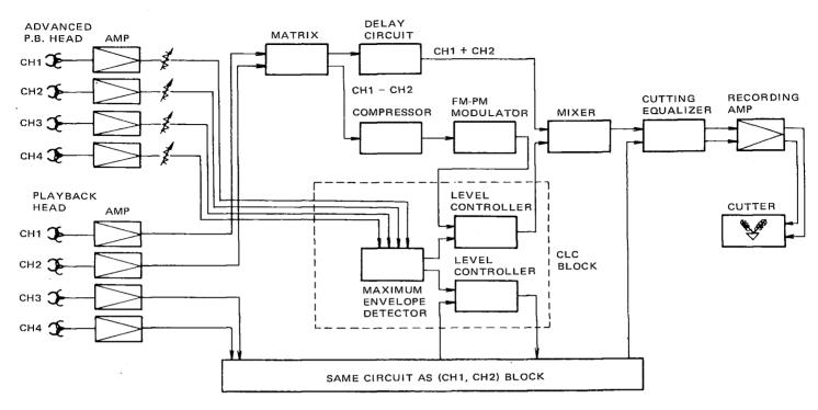
**BLOCK DIAGRAM OF CARRIER LEVEL CONTROLLER**
